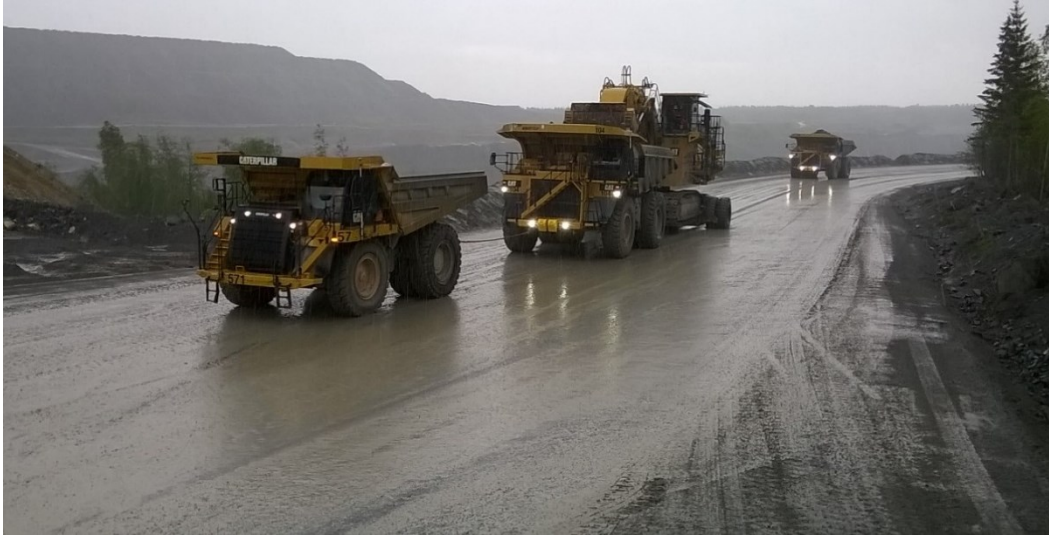
4 Koneensiirto kahdella louheautolla. Machinery transport with hauling trucks
