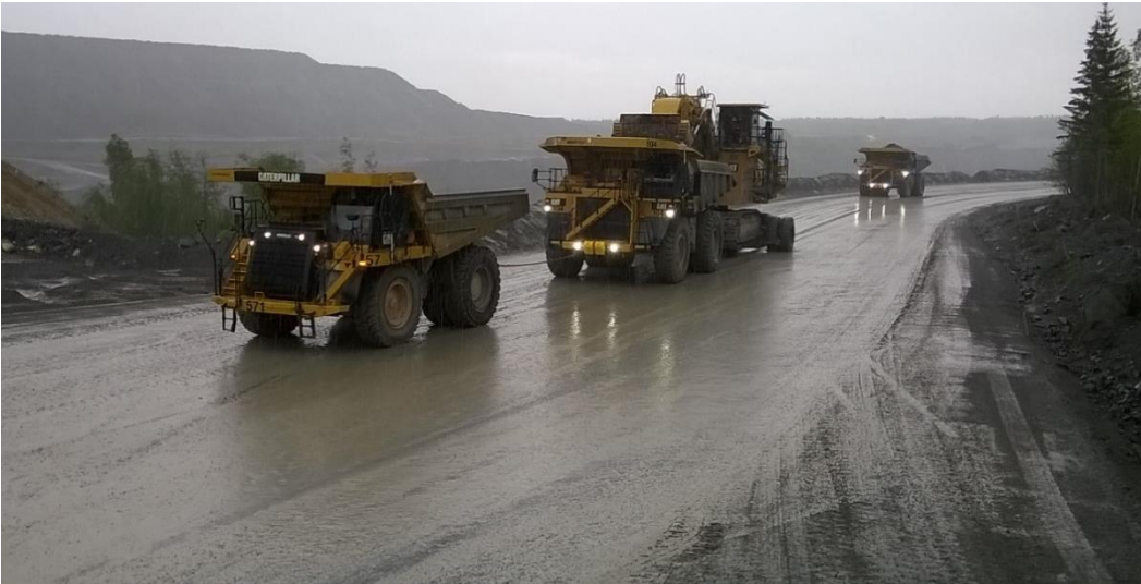
Kuva 3. Konesiirto kahdella louheautolla.
