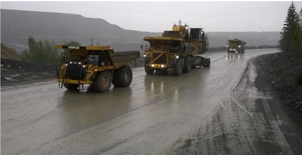
Kuva 3. Konesiirto kahdella louheautolla.
