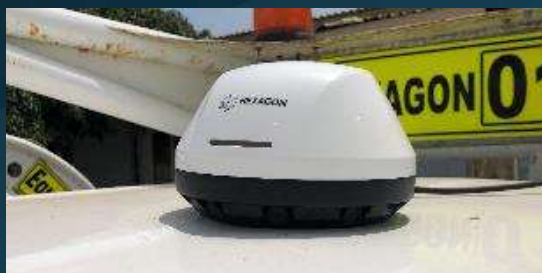
Smart Antenna kevyessä ajoneuvossa
