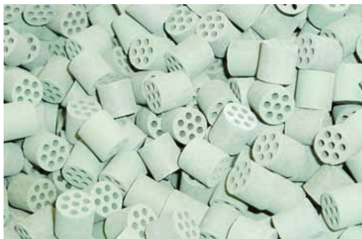
Kuva 5: Katalyyttimassa koostuu pienistä keraamisista pelleteistä. Yaran kehittämä teknologia vähentää \text{N}_2\text{O} -päästöjä jopa 90 prosenttia.
